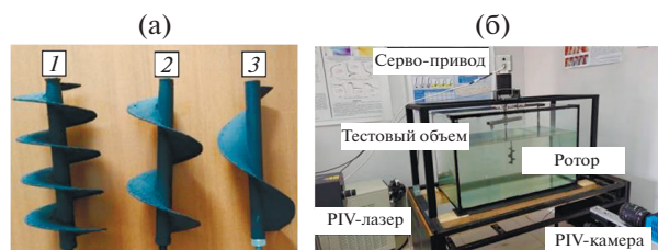
Рис. 13. Фотографии винтовых роторов с различными геометрическими параметрами (а) и экспериментальной установки (б) [55].
