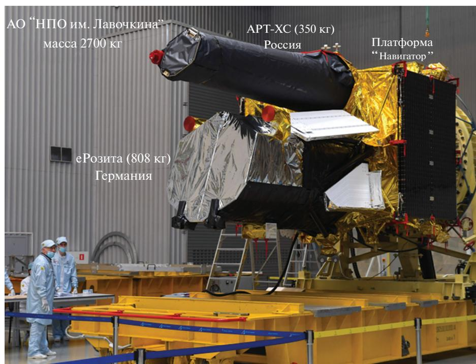
**Рис. 2.** Орбитальная обсерватория СРГ со сложенными солнечными панелями в сборочном цехе НПО Лавочкина перед отправкой на Байконур.
