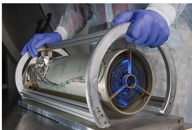
**Рис. 2.** Подготовка одной из зеркальных систем телескопа ART-XC к испытаниям на установке MSFC по измерению степени рассеяния света.
