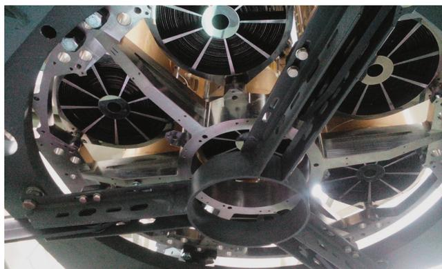
Рис. 4. Зеркальные системы телескопа ART-XC, установленные на монтажном стенде.
