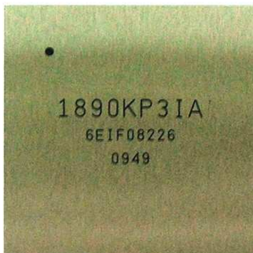
Коммутационная СБИС для Супер-ЭВМ на основе стандарта RapidIO
