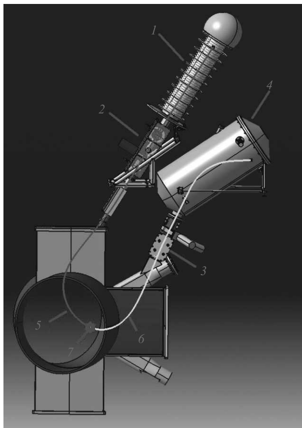
Рис. 2. (Цветной онлайн) ИВР диагностика на Т-10, сечение D. 1 – ускоритель; 2 – первичный ионопровод; 3 – вторичный ионопровод; 4 – анализатор; 5 – траектория первичного пучка ( T1^+ ); 6 – траектория вторичного пучка ( T1^{++} ); 7 – измерительный объем (SV) [7]
