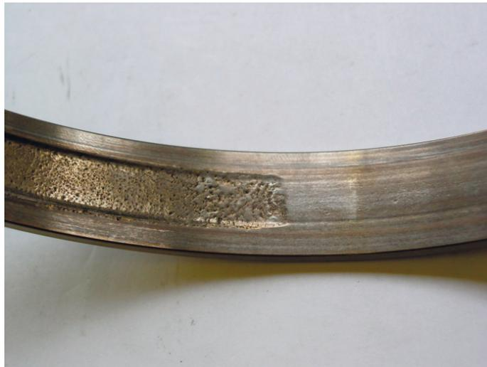
Рис. 7. Питтинг на наружном кольце подшипника опоры ротора.
