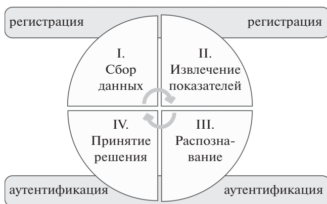
Рис. 2. Жизненный цикл непрерывной аутентификации.
