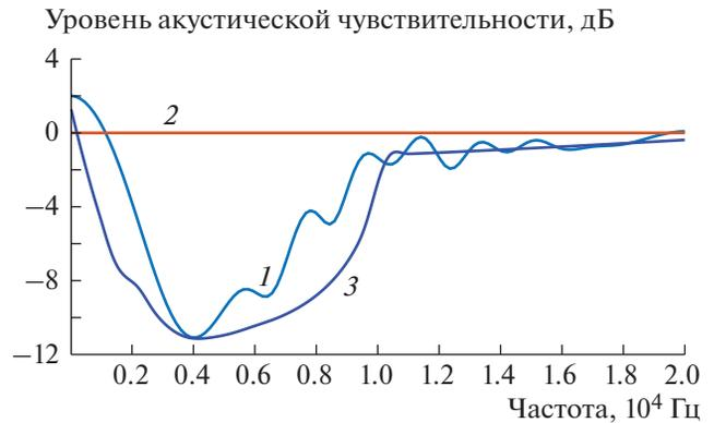
**Рис. 2.** Сравнение экспериментальных результатов и результатов работы модели: 1 – снижение уровня фазовой акустической чувствительности применением корпуса с известными параметрами, 2 – уровень 0 дБ (без корпуса), 3 – результат моделирования снижения уровня фазовой акустической чувствительности с применением корпуса с известными параметрами.
