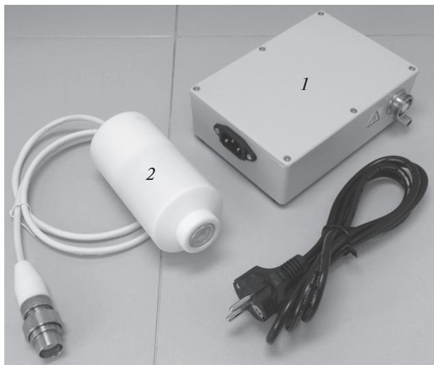
Рис. 1. Внешний вид портативной эксилампы. 1 – блок питания; 2 – излучатель.
