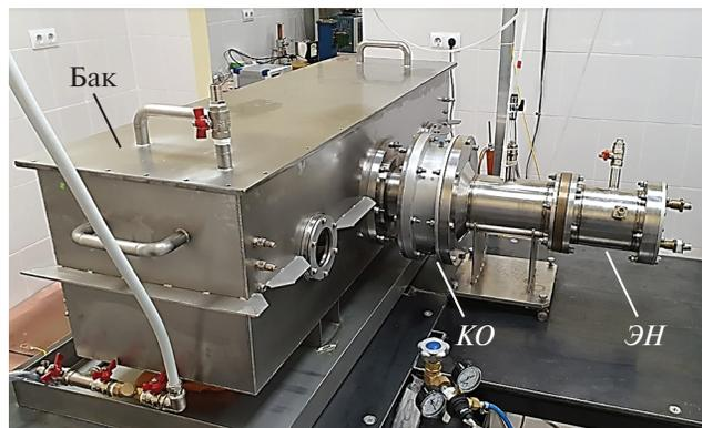
**Рис. 2.** Внешний вид генератора с кольцевым обострителем КО и эквивалентом нагрузки ЭН. Бак содержит две д.ф.л., два импульсных трансформатора, два л.г.р. и токосборный узел.
