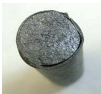
Рис. 1. Отрезанный кусок твэла, вид с торца. Для растворения использовали 10 моль/л раствор HNO 3 , содержащий 0.05 моль/л NaF и 0.1 моль/л Al(NO 3 ) 3 . Объем реагента-растворителя выбирали из условия неперевышения растворимости нитрата бериллия для данной системы, равной, как было предварительно установлено, 30 г/л по бериллию.
