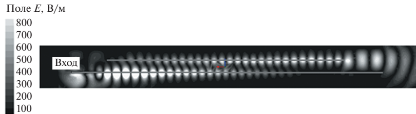
Рис. 18. Распределение интенсивности электрического поля в продольной плоскости XOZ.
