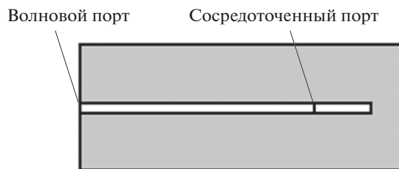
Рис. 13. Тестовая структура для выбора параметров входной части антенны Вивальди.
