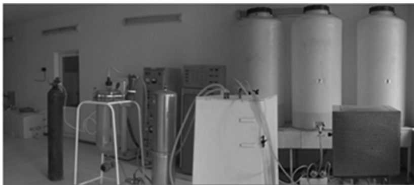
Рис. 5. Вид экспериментальной установки получения металлического магния из водных растворов MgCl 2 .
