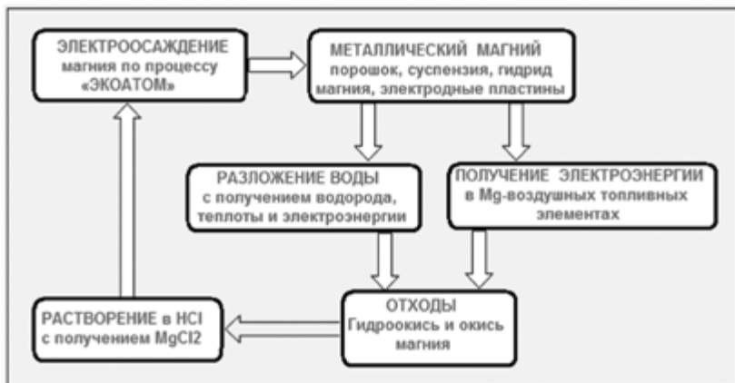
Рис. 7. Магниевый энергетический цикл.
