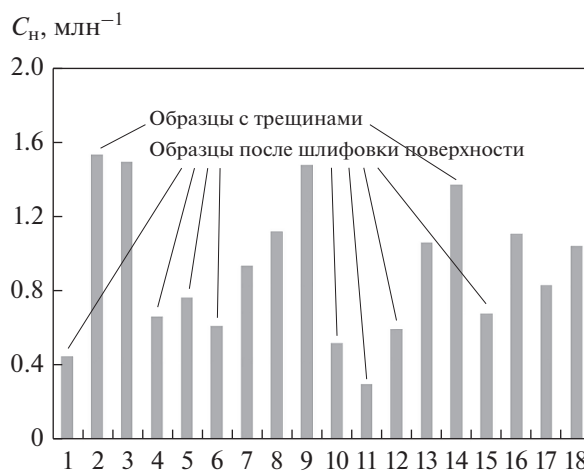
Рис. 7. Диаграмма результатов измерения концентрации водорода в малых образцах.
