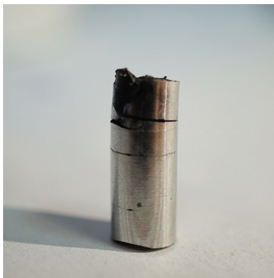
Рис. 2. Изображение фрагмента с трещиной рабочей части разрушенного в коррозионной среде образца.
