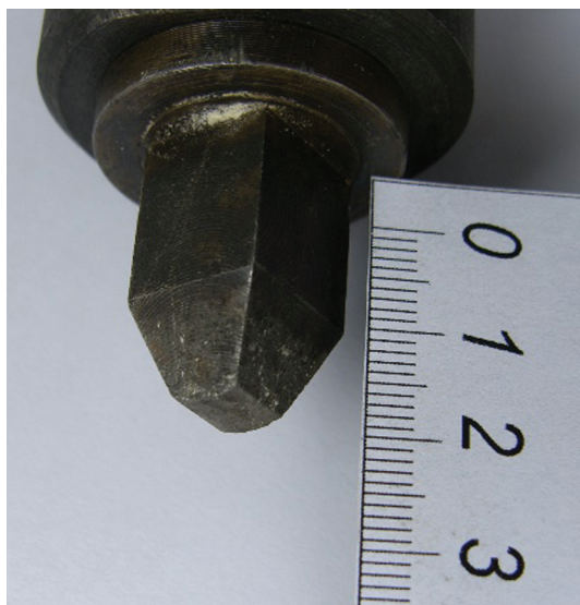
Рис. 2. Внешний вид индентора испытательной машины.
