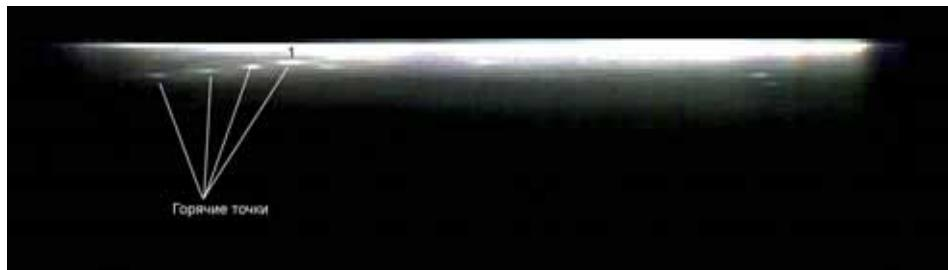
Рис. 1.14. RGB образ гиперспектрального изображения горения смеси 40%  $H_2$  – воздух, инициированного платиновой проволокой, полученный при использовании модифицированного гиперспектрометра ВИД-ИК3,  $T_0 = 320$  °C,  $P_0 = 1$  атм, спектральный интервал 550 – 650 нм
