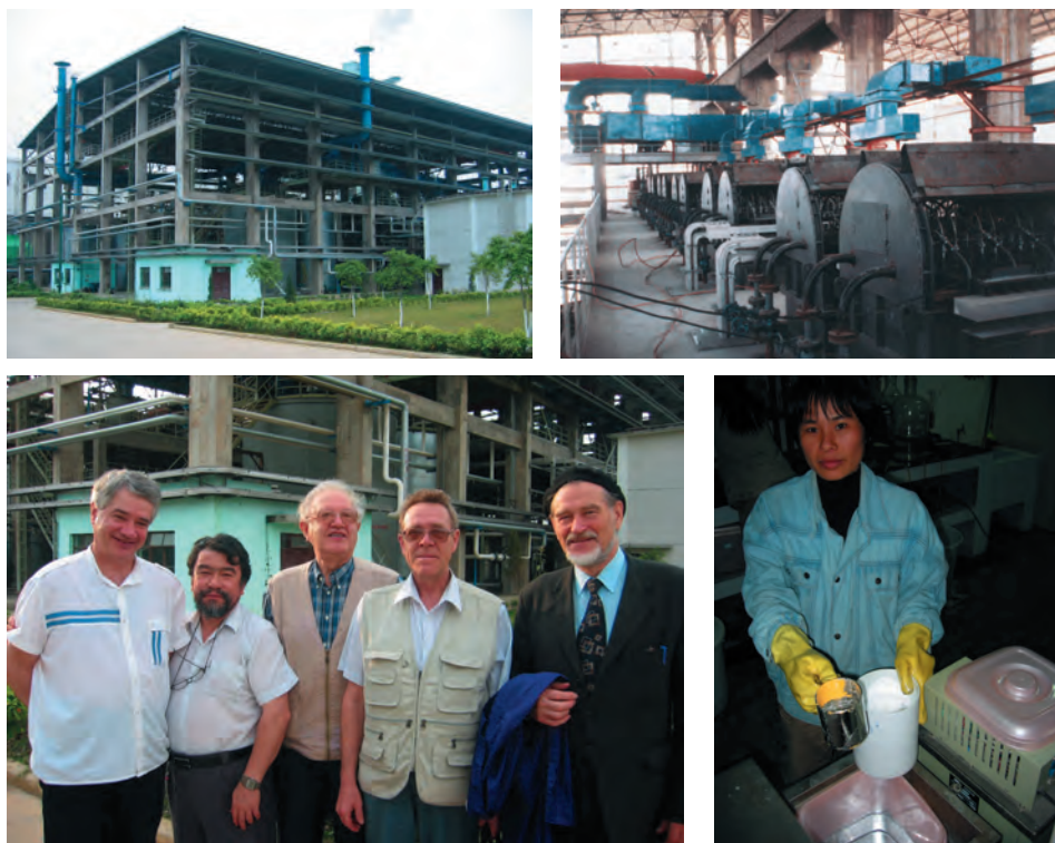
Рис. 4.36. Общий вид цеха (тропический вариант) завода в г. Пин-Го (КНР); ряд электролизеров; участники запуска производства из ИХТТ УрО РАН (справа налево: проф. С.П. Яценко, к.т.н. В.Н. Диев, к.т.н. Г.М. Рубинштейн) и лаборант с первым галлием, полученным по российской технологии
