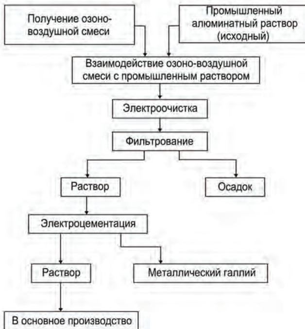
Рис. 4.11. Технологическая схема получения галлия на ПАЗ (Казахстан)
