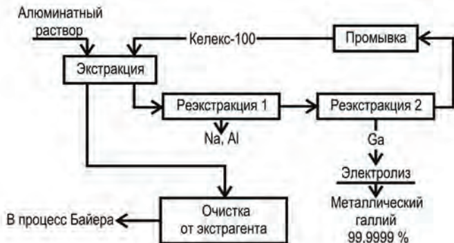
Рис. 6.7. Схема экстракционного извлечения галлия из щелочных алюминатных растворов с использованием Kelex-100
