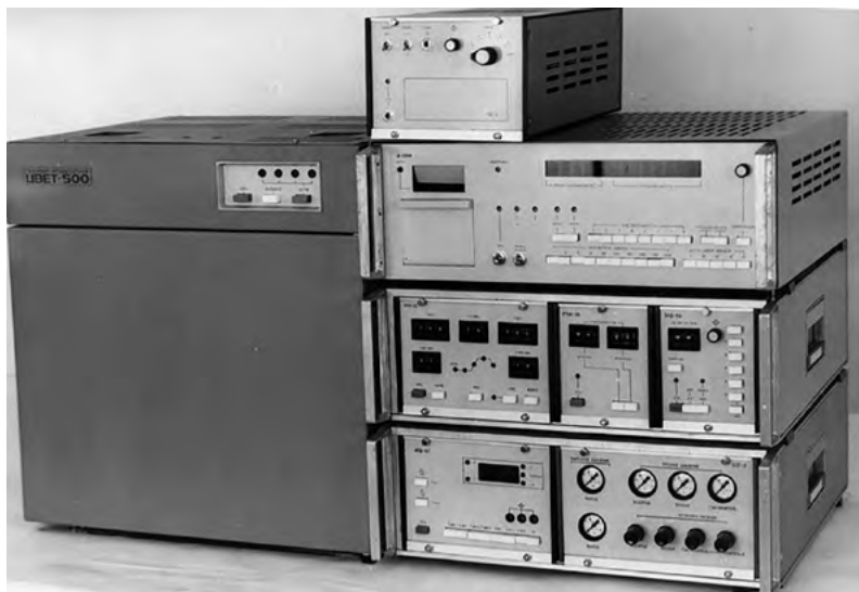
Рис. 4.13.3. Самый массовый газовый хроматограф – Модель ЦВЕТ-500
