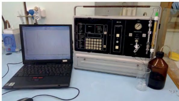
Рис. 5.6.5. Ионный хроматограф ХПИ-1
