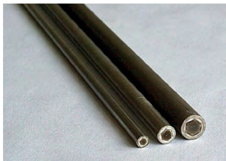
Рис. 5.8.6. Прямые ПКК с различным диаметром капилляров в защитных кассетах.
