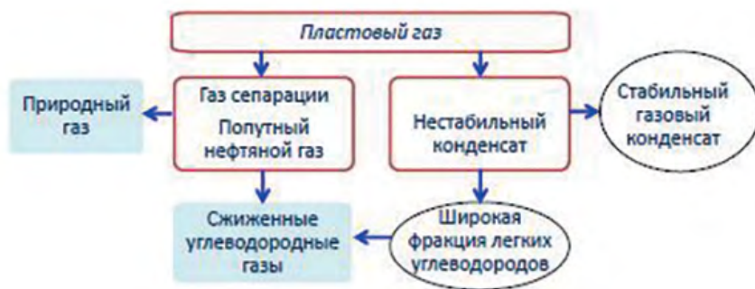
Рис.3.13.3. Упрощенная схема первичной переработки газоконденсатного сырья.
