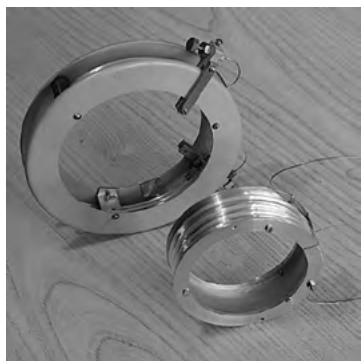
Рис. 5.8.7. Фотография коммерческих спиральных колонок диаметром 125 и 85 мм в кассетах.
