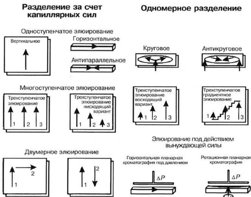
Рис. 5.5.2. Методы элюирования в планарной хроматографии
