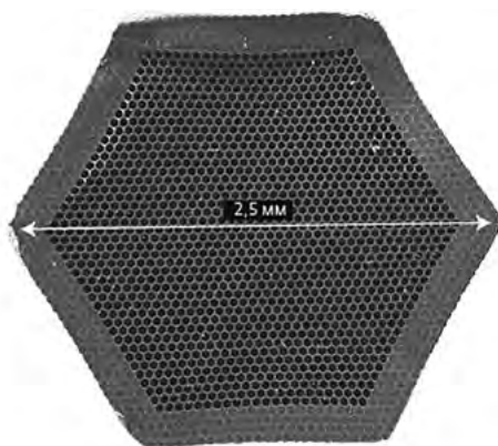
Рис.5.7.1. Микрофотография поперечного среза многоканальной трубки. Число капилляров в пакете – 1375, диаметр капилляра – около 40 мкм: а) общий вид; б) капилляры ПКК при увеличении. Фото из канд. дисс. Патрушева Ю.В. [8]
