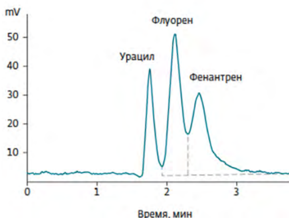
Рис.5.7.7. Разделение на ПЭК длиной 150 мм с диаметром капилляра 20 мкм
