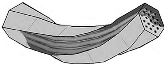
Рис.5.7.4. Фрагмент спиральной поликапиллярной колонки, закрученной вдоль продольной оси
