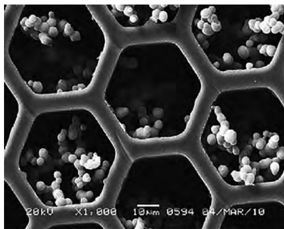
Рис.5.7.10. Фрагмент ПКК с капиллярами 40 мкм, внутри которых проведен синтез монолита на основе ДВБ/стирол
