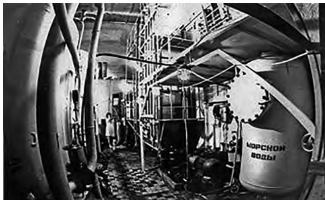
Рис.3.7.5. Пилотная установка по извлечению из морской воды Li, K, Cs и Sr. Сахалинская ГРЭС, 1986 год
