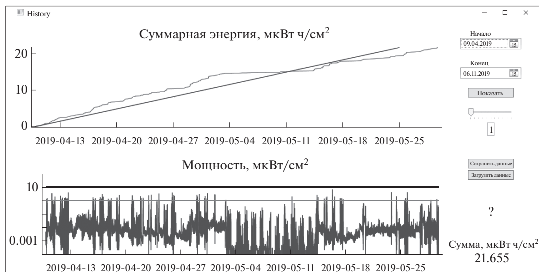
Рис. 3. Окно программы при выводе записанной истории: интегральная принятая энергия (верхний график); текущая принимаемая мощность (нижний график).
