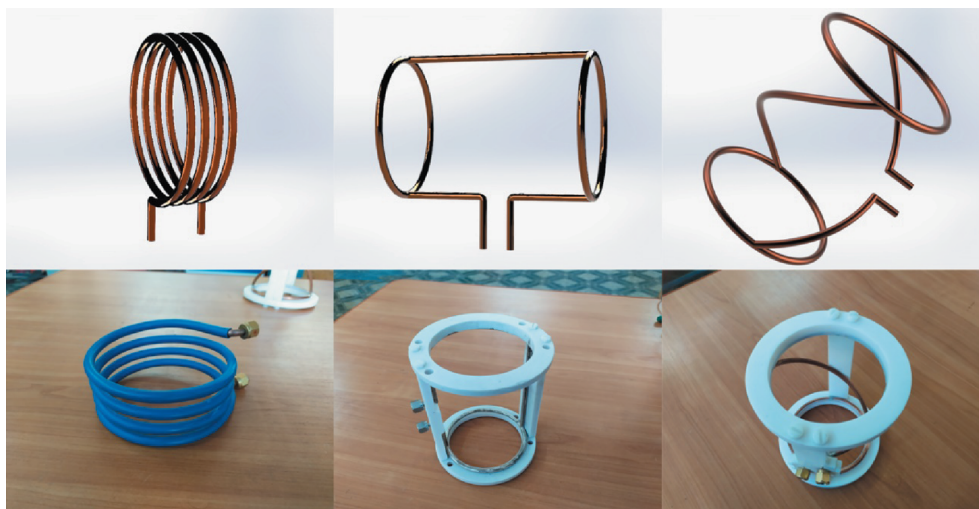
Рис. 4. Типы использованных ВЧ-антенн: витковая ( l = 3.6 см, m = 0 ); НПН ( l = 16 см, m = \pm 1 ); Н–Н ( l = 15 см, m = \pm 1 ); диаметр медной трубки d = 6 мм.
