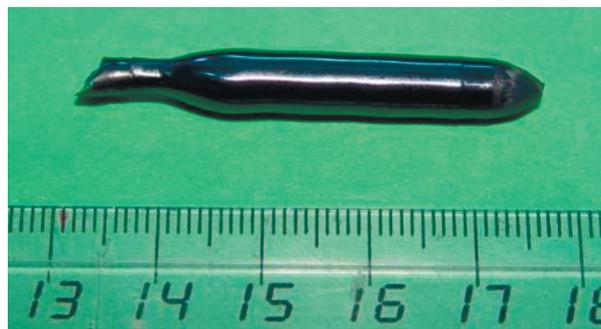
Рис. 1. Изображение выращенного монокристалла  $\text{Ga}_{2-x}\text{Fe}_x\text{O}_3$  ( $x = 1$ ).
