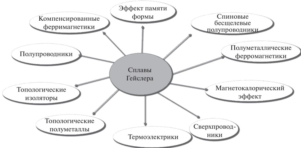
Рис. 1. Различные типы сплавов Гейслера и их функциональные свойства.
