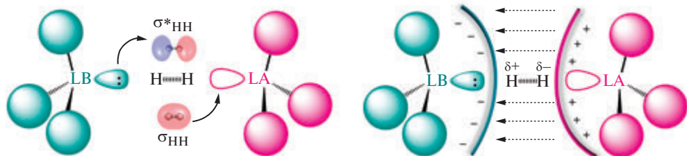
Рис. 59. Предполагаемые способы активации водорода стерически затрудненными Льюисовыми парами (FLP) за счет орбитальных (слева) и электростатических (справа) взаимодействий. По данным работы [239]
