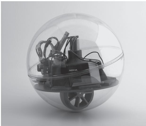
Рис. 1. Сферический робот
