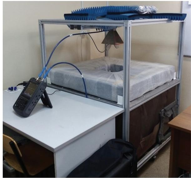
Рис. 1. Антенный стенд для измерений коэффициента экранирования в свободном пространстве.
