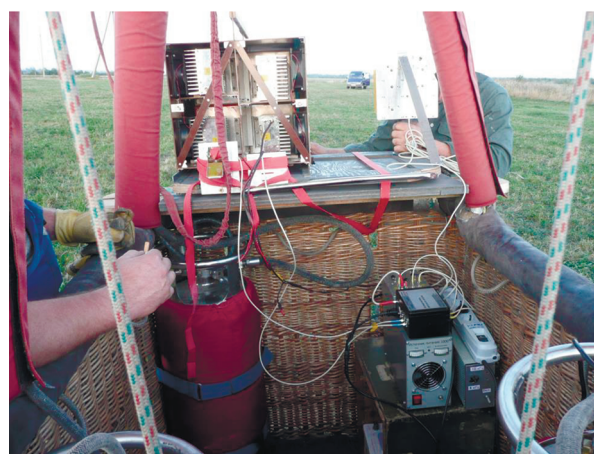
Рис. 6. Размещение СШП-сборки 2 \times 2 в корзине воздушного шара.
