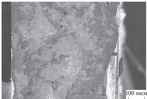
Рис. 10. Электронная микрофотография поперечного скола таблетки  $\text{CsAg}_4\text{Br}_{2.5}\text{I}_{2.5}$ .
