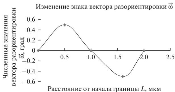
**Рис. 4.** Изменение вектора разориентировки  $\vec{\omega}$  вдоль оборванной, малоугловой, межблочной границы кручения, сформировавшейся в ромбовидной нанотонкой ПДС гексагонального селена.
