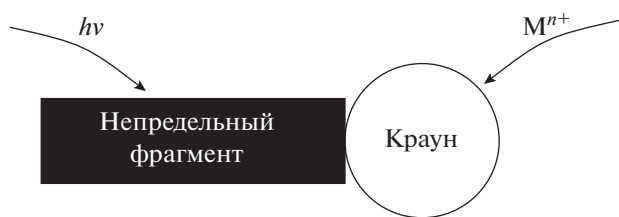
Рис. 1. Схематическое представление фотопереключаемых супрамолекулярных устройств на основе краун-содержащих непредельных соединений (КНС).
