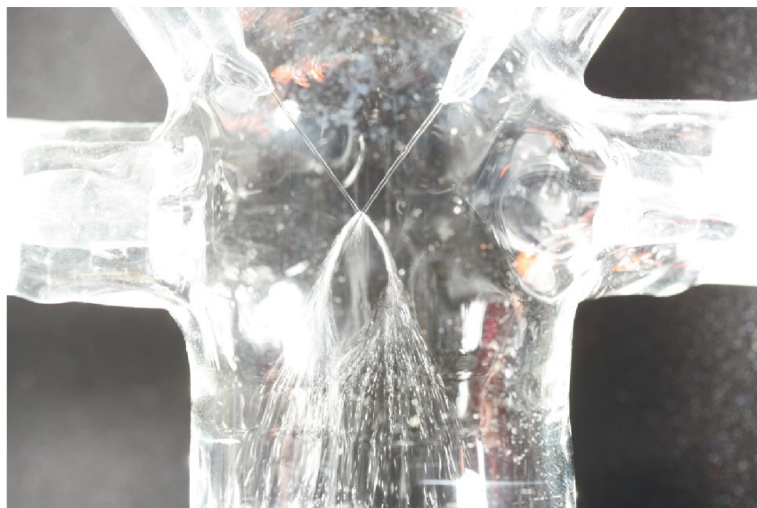
Рис. 5. Фотография сталкивающихся струй и жидкостной пелены, образующейся в МРСС, при угле между струями 71^\circ . Плоскость пелены лежит под углом 45^\circ к плоскости фотоснимка.
