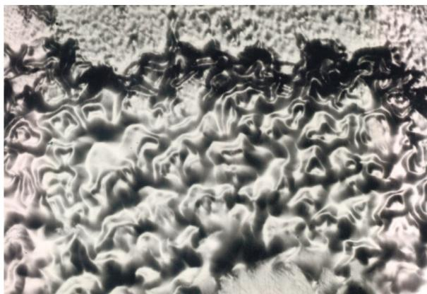
Рис. 3. Морфология поверхности пленки ванадия после вакуумного нагрева до 660°C.
