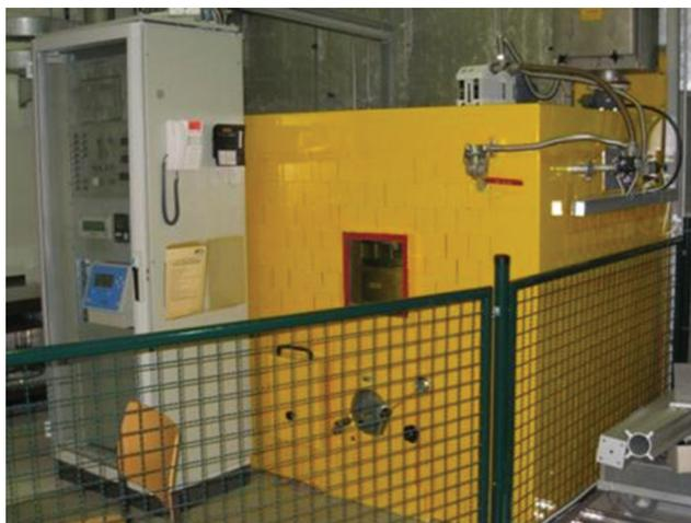
Рис. 24. Общий вид пневматической транспортной установки и стойки управления (прототип).
