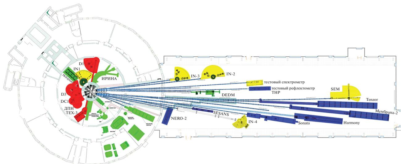
Рис. 2. Схема размещения экспериментальных установок в зале горизонтальных каналов и нейтронноводном зале.
