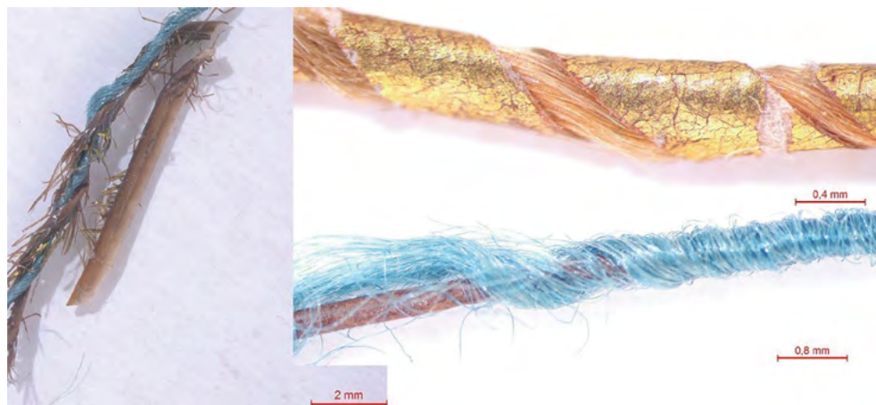
Илл. 11. Макросъёмка нити из перьев павлина, золотной нити и нити с основой из материала растительного происхождения (пальмовое волокно). Фото П.Е. Кандыба
