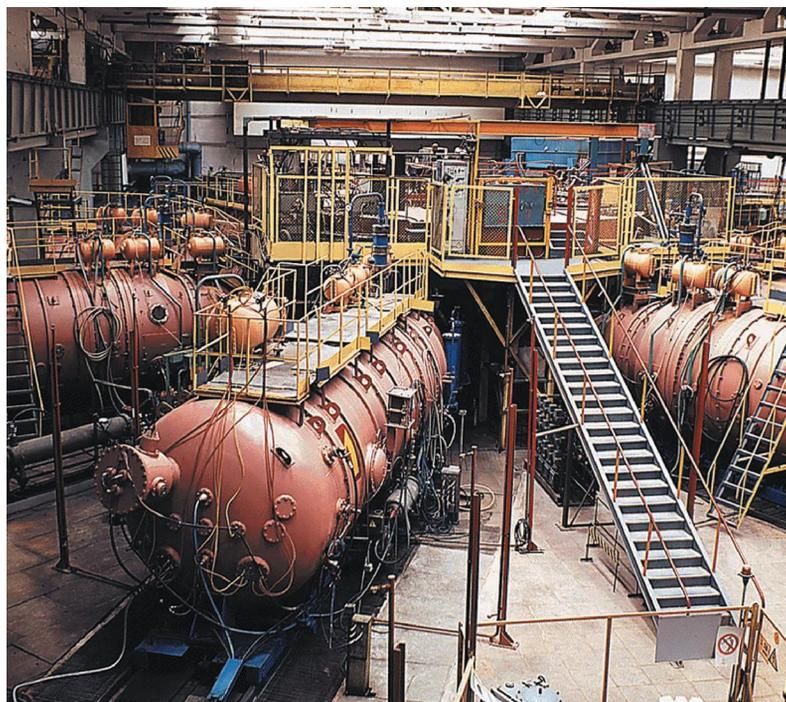
**Рис. 6.** Импульсный генератор “Ангара-5”, ГНЦ РФ Троцкий институт инновационных и термоядерных исследований госкорпорации “Росатом”
