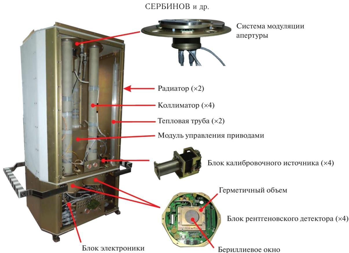
Рис. 12. Состав рентгеновского монитора СПИН-Х1-МВН.
