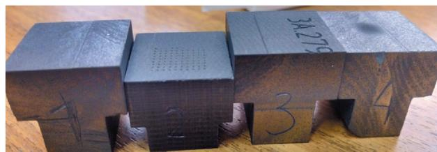
**Рис. 3.** Графитовые образцы после облучения пучками электронов в установке АЭЛТК 12.
