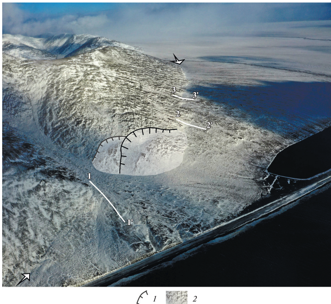
Рис. 4. Общий вид тектонического уступа (показан стрелками). Георадарные профили 1–1', 2–2', 3–3'. 1 – стенки отрыва оползней; 2 – скальные оползни
