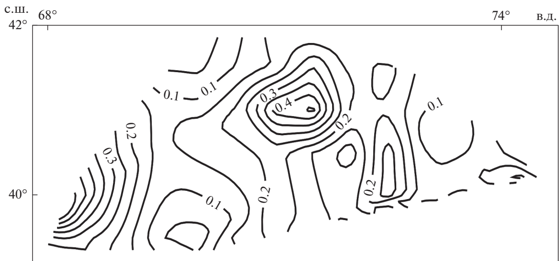
Рис. 8. Тангенциальные напряжения \sigma_{\tau}/2 \times 10^8 Па на глубине 15 км по результатам численной модели.
