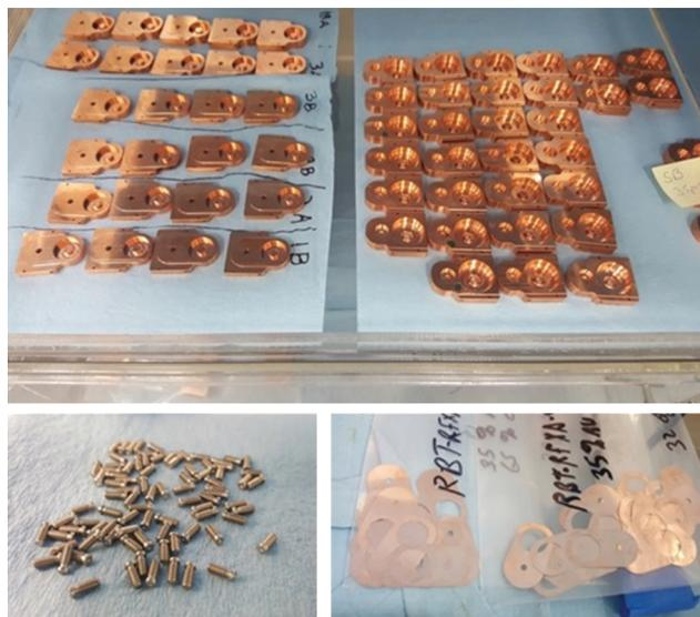
**Рис. 11.** Ячейки ускоряющей структуры типа к.д.в. частотного X-диапазона, изготовленные традиционным “поячеечным” способом, и вспомогательные компоненты для их соединения и пайки.
