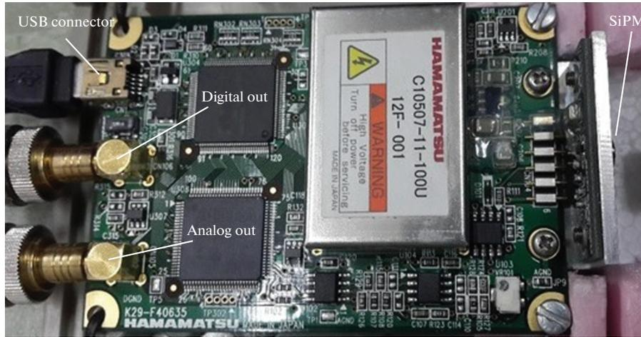
Рис. 1. Фотография модуля МРСС.
