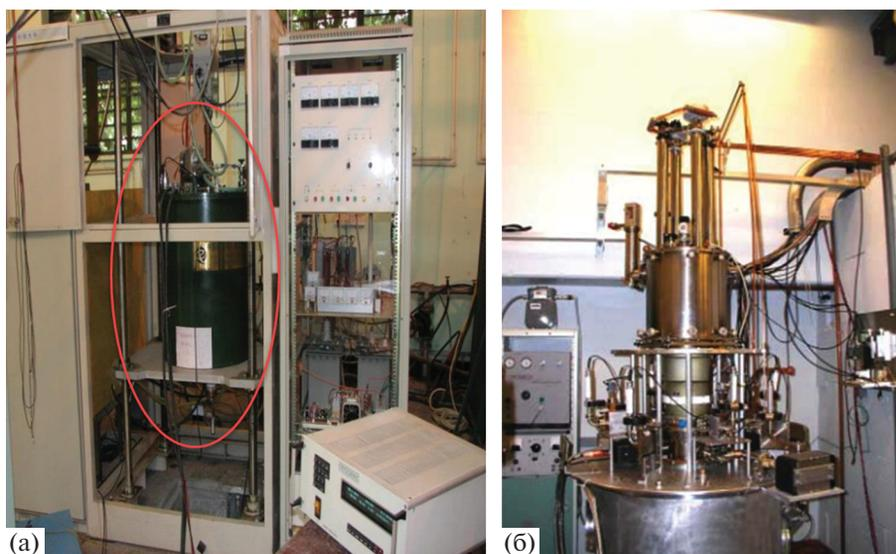
**Рис. 3.** Источники высокой импульсной мощности частотного Ка-диапазона: **а** – 34 ГГц-гироклистрон с мощностью 500 кВт, длительностью импульса 100 мкс и частотой повторения 1000 Гц, аналогичный разработанному НПО ГИКОМ [37], **б** – 34 ГГц-магникон с мощностью 17 МВт, длительностью импульса 0.25 мкс и частотой повторения 1–2 Гц, разработанный в Институте ядерной физики имени Г.И. Будкера СО РАН [38].
