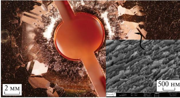
Рис. 12. Характерная картина повреждения поверхности ускоряющей структуры вследствие в.ч.-пробоя (фотография В.А. Долгашева).
