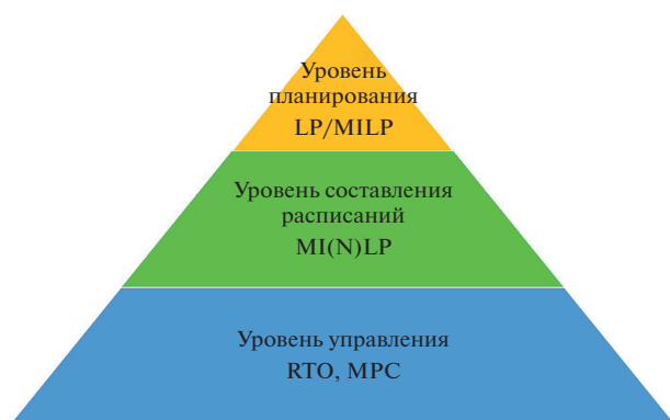
Рис. 1. Иерархическая структура моделей оптимизации в масштабах всего предприятия: MILP — Mixed Integer Linear Programming (смешанное целочисленное линейное программирование), MINLP — Mixed Integer Nonlinear Programming (смешанное целочисленное нелинейное программирование), RTO — Real Time Optimization (оптимизация в реальном времени), MPC — Model Predictive Control (модель прогнозирующего управления).
