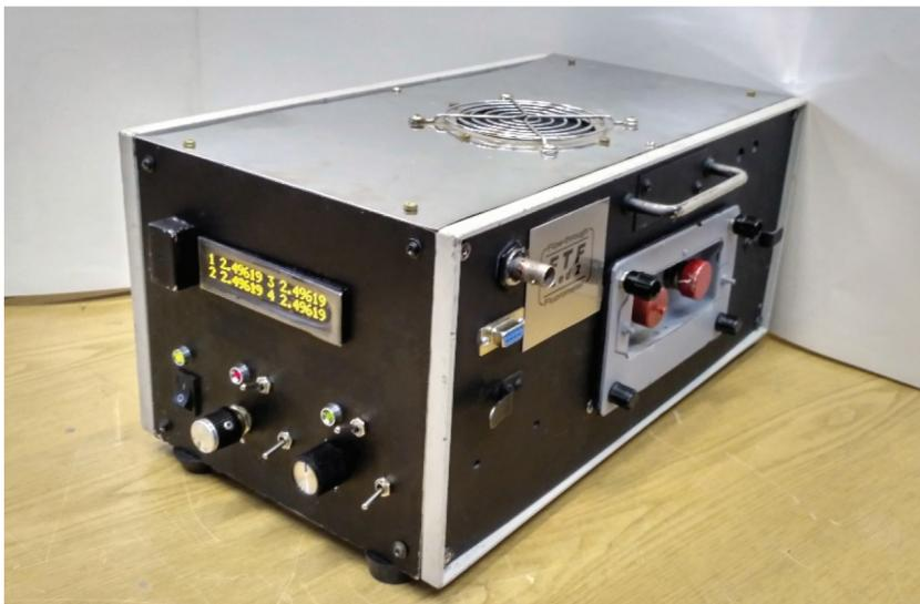
Рис. 1. Общий вид проточного двухканального флуориметра ПФД-2М.
