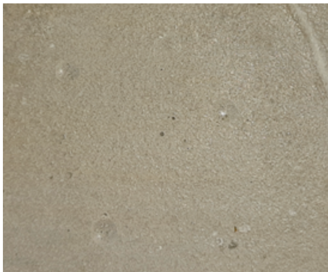
Рис. 1. Поверхность плитки из цементно-песчаной смеси с остаточными отпечатками от сферического индентора.
