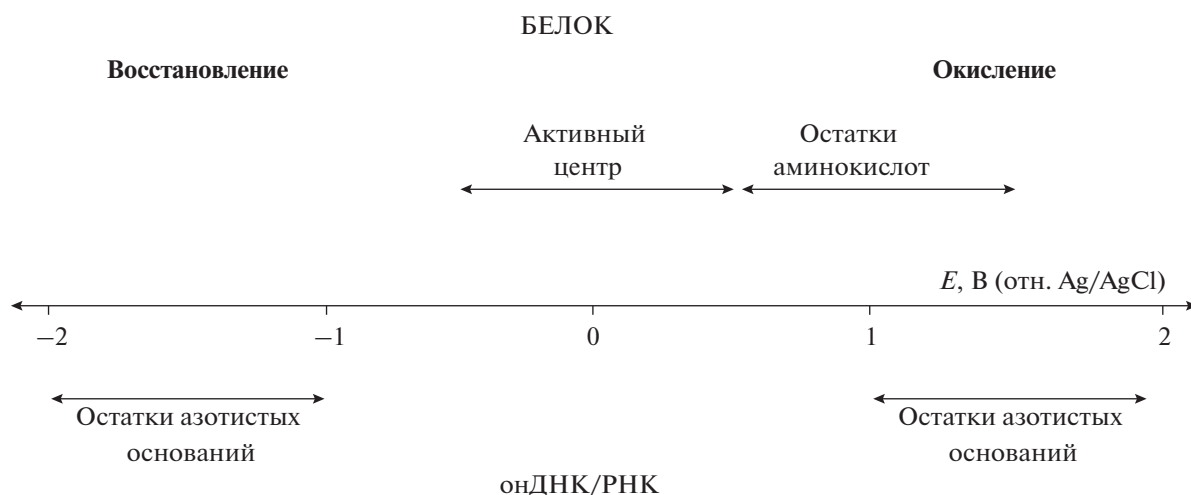
Рис. 3. Потенциалы сигналов окисления и восстановления белков и нуклеиновых кислот на твердых электродах.
