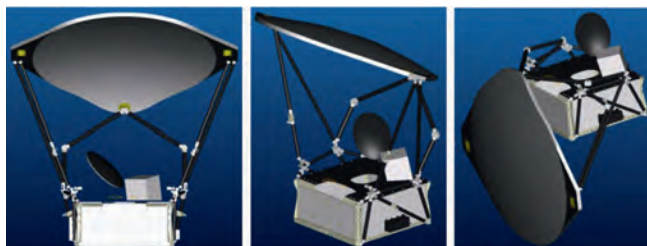
Рис. 13.2. Радиометрический комплекс AMSR 2 с раздвигаемым основным рефлектором
