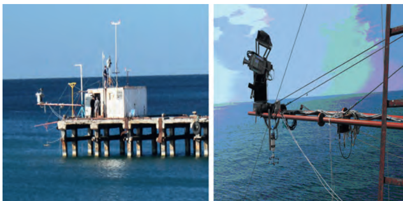
Рис. 10.3. Общий вид измерительного комплекса (слева) и внешний вид сканирующей платформы (справа)
