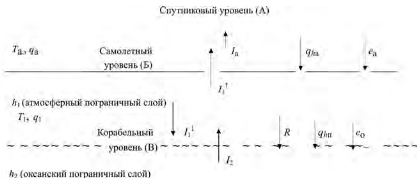
Рис. 4.1. Схема параметризации тепловых и электромагнитных потоков в СОА
