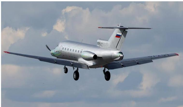
Летные испытания гибридной турбоэлектрической силовой установки с применением технологий высокотемпературной сверхпроводимости в составе летающей лаборатории СибНИА им. С.А. Чаплыгина Як-40ЛЛ
