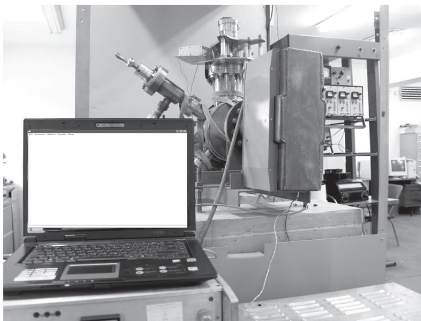
**Рис. 3.** Экспериментальная установка для получения дифракционных картин. (а) – структура экспериментальной установки, (б) – общий вид экспериментальной установки.
