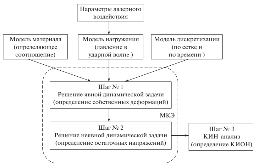
Рис. 1. Блок-схема численного анализа.
