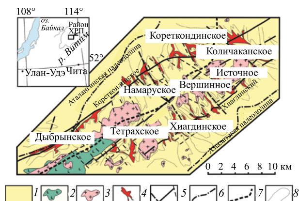
Рис. 1. Схематическая геологическая карта Хиэгдинского рудного поля (по данным работы [3]). 1, 2 – N-Q отложения: 1 – терригенные, вулканогенно-осадочные, 2 – платобазальты; 3 – породы фундамента (граниты); 4 – проекции урановорудных залежей на поверхность; 5 – разрывные нарушения; 6 – оси палеодолин; 7 – ось Байсыханского поднятия; 8 – контуры палеооврагов.
