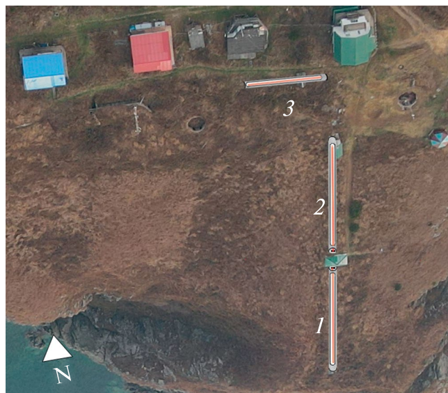
Рис. 1. Схематическое расположение лазерных деформографов на м. Шульца: 1 – лазерный деформограф с длиной измерительного плеча 52.5 м, 2 – лазерный деформограф с длиной измерительного плеча 52.5 м, 3 – лазерный деформограф с длиной измерительного плеча 17.5 м
