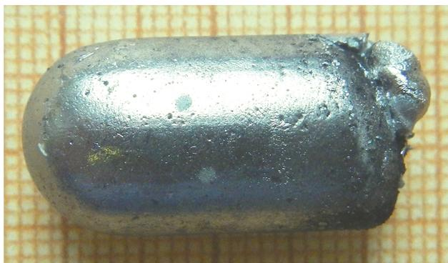
Рис. 1. Внешний вид слитка композита состава  $\text{Cd}_3\text{As}_2$  :  $\text{MnAs}$  = 75 : 25 мол. %.
