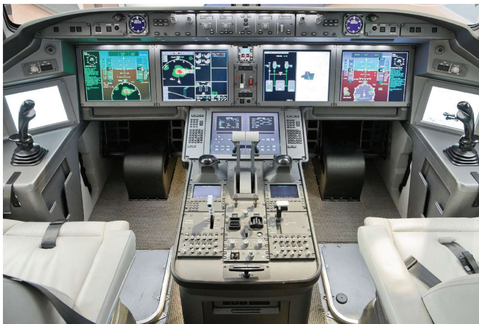
Рис. 1. Стенд КБО МС-21 ГосНИИАС
