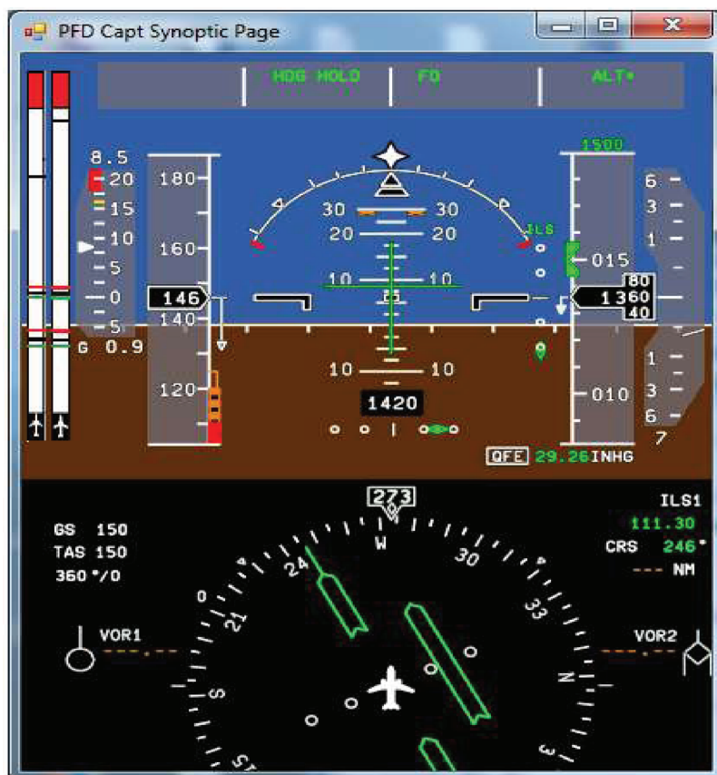
Рис. 10. Предполагаемое расположение разработанного сигнала (слева две светлые полосы) на PFD самолета MC-21
