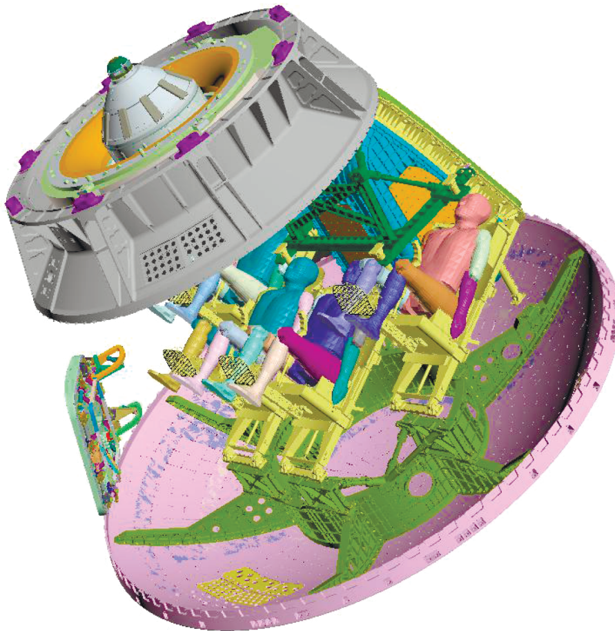
Рис. 2. Расположение членов экипажа, представленных в виде антропоморфных фантомов, в креслах внутри КК, оболочка КК условно не показана.
