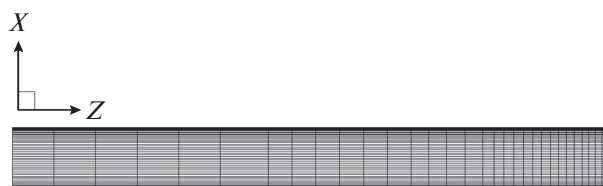
Рис. 5. Распределение расчетных ячеек на поверхности лопасти для сетки 160 тыс. ячеек.
