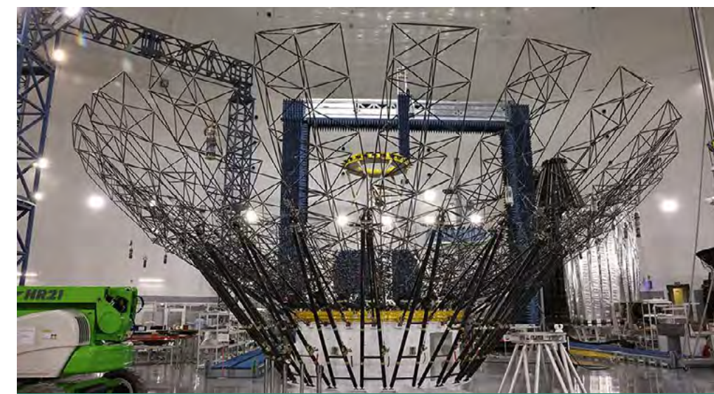
Каркас главного зеркала космической обсерватории «Миллиметрон» («Спектр-М»)
