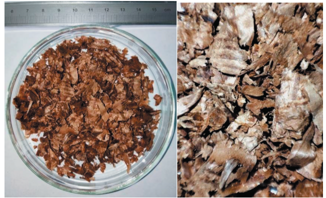
Рис. 1. Фотографии древесной стружки после парового взрыва при температуре 220°C, давлении 2.3 МПа, времени выдержки 1 мин.
