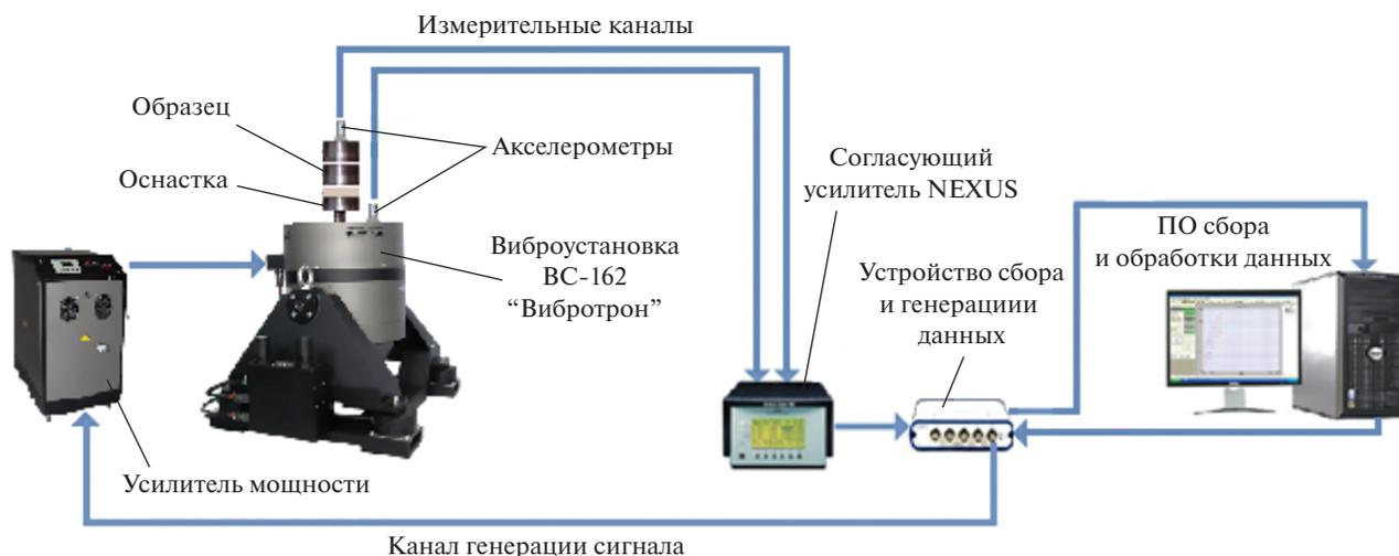
Рис. 1. Функциональная схема экспериментальной установки.
